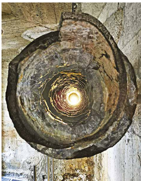
Obr. 5. Karlovy Vary, potrubí pro vřidelní vodu zanesené usazeninami (sintry) v expozici Starého suterénu Vřidelní kolonády. Foto: Lubomír Zeman, 2024.
