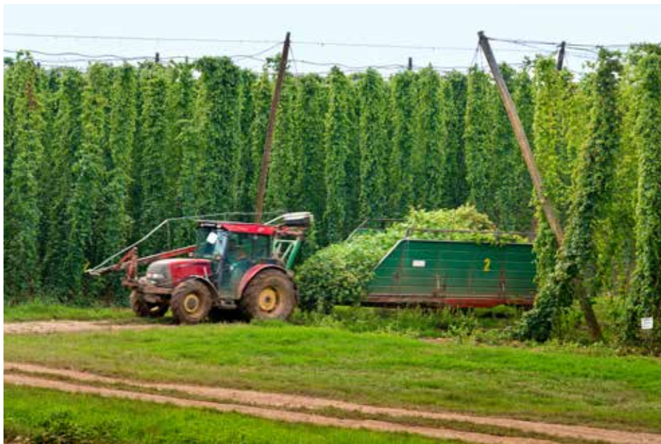
Obř. 6. Stekník, traktor se strhávačem na chmelnici odváží stržené révy na česačku, kde je chmel strojově očesan, usušen a slisován do hranolů. Foto: Václav Mach, 2019.
