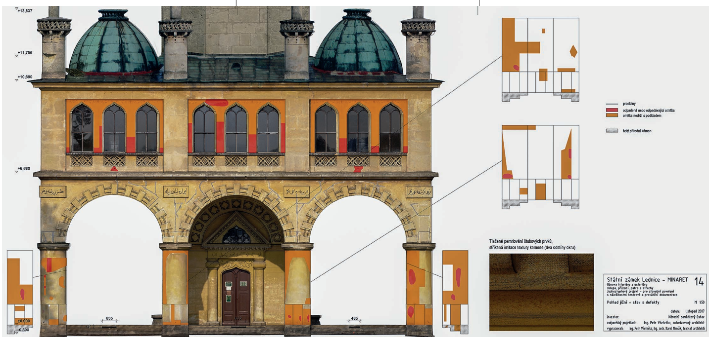
Obr. 4. Minaret, pohled jižní, stav s defekty, výkres č. 14, aktualizovaný jednodušňový projekt pro stavební povolení s náležitostmi tendrové a prováděcí dokumentace, listopad 2007, měřítko 1 : 50. Vypracovali: Ing. Petr Všecký, Ing. arch. Karel Menšík, Transat architekti.
