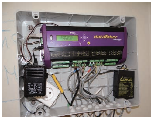
Obr. 5. Měřicí ústředna DataTaker a strunový tenzometr. Převzato z: http://www.trinstruments.cz/datalogger-data-taker-di85gm , vyhledáno 22. 11. 2016.
