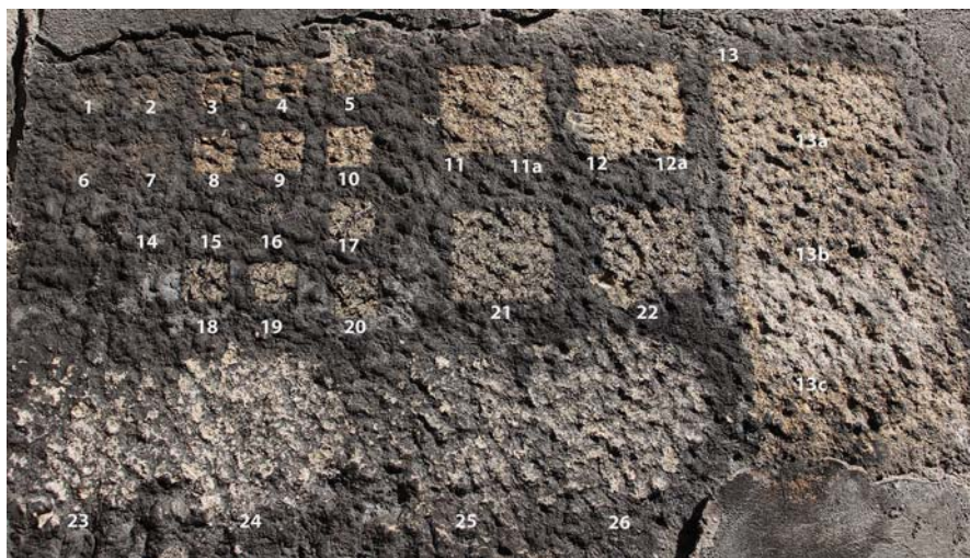
Obr. 3. Zkoušky čištění: hydrogenubličitan vápenatý (č. 25, 26), uhličitan vápenatý (č. 23, 24), mikropískování s různými abrazivy (č. 14–22), laserové čištění (č. 1–12). Foto: Roman Kolář, 2015.
