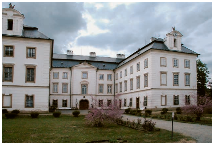
Obr. 6. Vizovice (okr. Zlín), zámek. Komínové hlavy zakončené zdobnými hlavicemi zabraňujícími zatékání; v severním křídle (vpravo) okenní výplně zakryté benátskými žaluziemi. (Foto: Jan Červenák, 2013)
