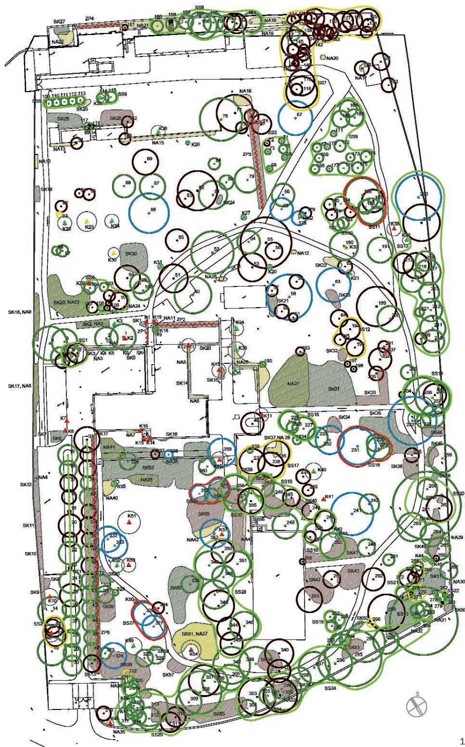
Obr. 16. Výkres dendrologického průzkumu zahrady. Polohopis dřevinných vegetačních prvků je vytvořen nad pasportem zahrady, resp. zaměřením objektu. Výkresová část obsahuje bodové dřevinné vegetační prvky, které jsou znázorněny průmětem koruny (barva kružnice odpovídá sadovnické hodnotě), středovou značkou a identifikátorem; plošné dřevinné vegetační prvky, které jsou znázorněny polygonem (barva výplně odpovídá dendrologickému potenciálu); liniové dřevinné vegetační prvky, které jsou v případě stromořadí znázorněny přímkou, jež spojuje okrajové stromy stromořadí (barva přímkové odpovídá dendrologickému potenciálu), v konkrétním případě jsou hodnoceny i stromy ve stromořadí. FLORART, 2011
