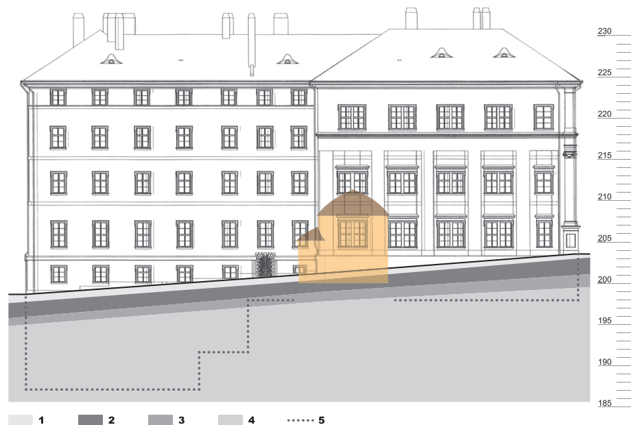
Obr. 24. Generalizovaný rekonstrukční řez Malostranským náměstím před severní frontou jezuitského profesního domu (čp. 2). Vysvětlivky: 1 – novověká partie nadloží; 2 – středověká partie nadloží; 3 – svahové sedimenty s nálezy pravěké keramiky; 4 – svahové sedimenty bez antropogenních nálezů; 5 – rozsah sklepů domu čp. 2. Výškové umístění rotundy sv. Václava podle Čiháková – Müller (pozn. 3), s. 28.
